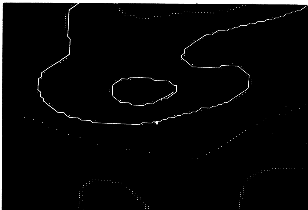
Figure 3. Partie agrandie d'un bloc montrant les segments cotés et non cotés de courbes de niveau. Le trait plein dénote les courbes qui font actuellement l'objet d'une attribution de cotes. Les points très espacés orientés horizontalement près du centre de l'image représentent une courbe déjà cotée. Les deux ensembles de points au bas de l'image restent à coter
