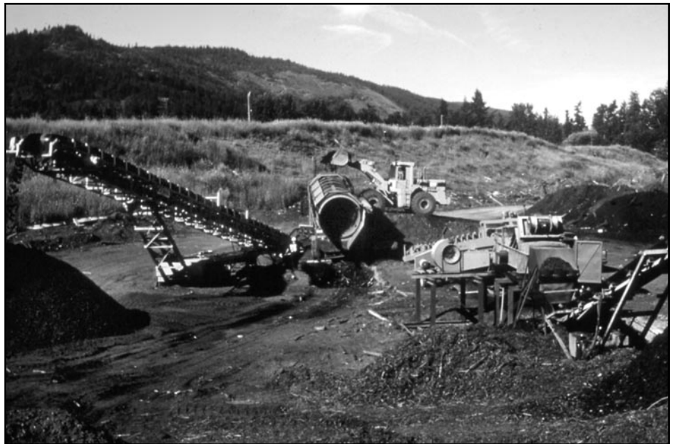
Les résidus de parcs de triage ont été séparés à l'aide d'un trommel cribleur. L'analyse des caractéristiques chimiques et physiques des fractions les plus fines a révélé que ce matériau pouvait être utilisé pour la remise en état des sols.
