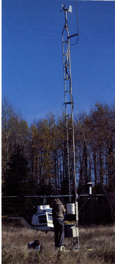
Les données des stations météo-incendie manuelles et électroniques servent au calcul des composantes du système IFM.
