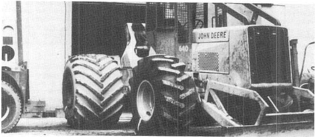
Figure 1. Pneus ordinaires 23,1 - 26 (avant) gonflés à 152 kPa (22 lb/po<sup>2</sup>) et pneus à basse pression 66 x 43 - 25 (arrière) gonflés à 83 kPa (12 lb/po<sup>2</sup>)<sup>a</sup>.
