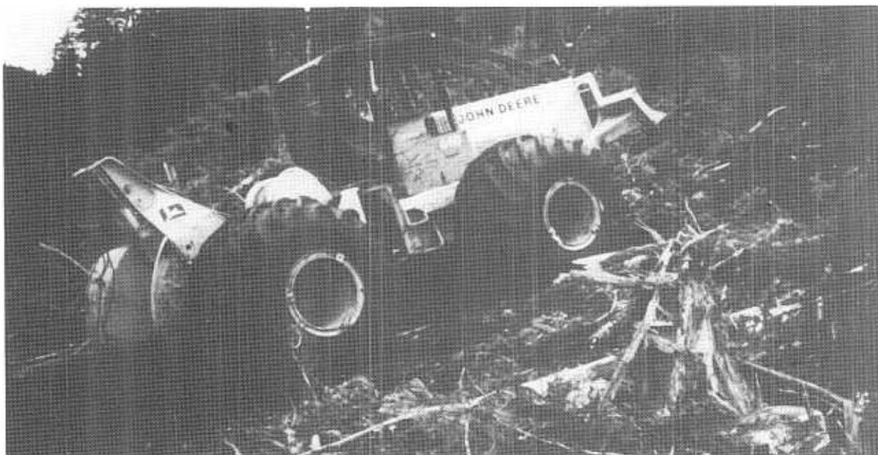
*Figure 3. Pneus à basse pression montés sur une débusqueuse JD640 équipée d'un treuil avec câble tracteur.*
