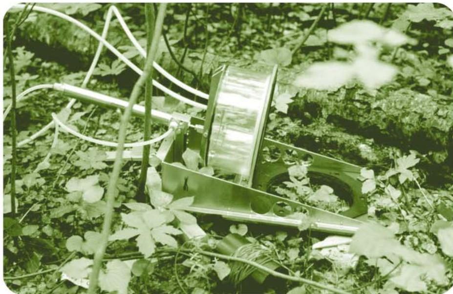
Appareil pour la mesure de la respiration du sol.
