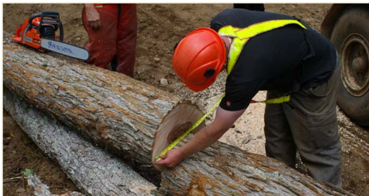
“Mesurage de cœur de moins de 50%, pour le placage d’érable à sucre”
