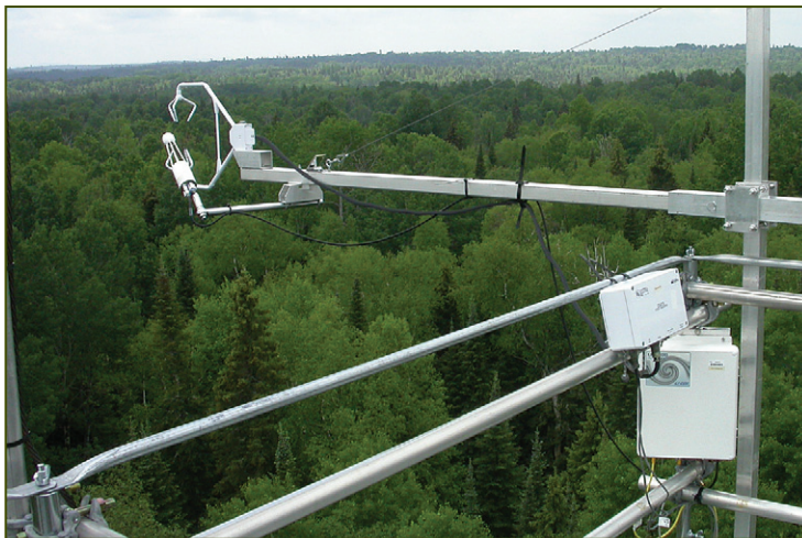
Image 3. L'analyseur à infrarouge et l'anémomètre sonique de la tour du lac McKeown, surplombant une forêt boréale mixte mature.
