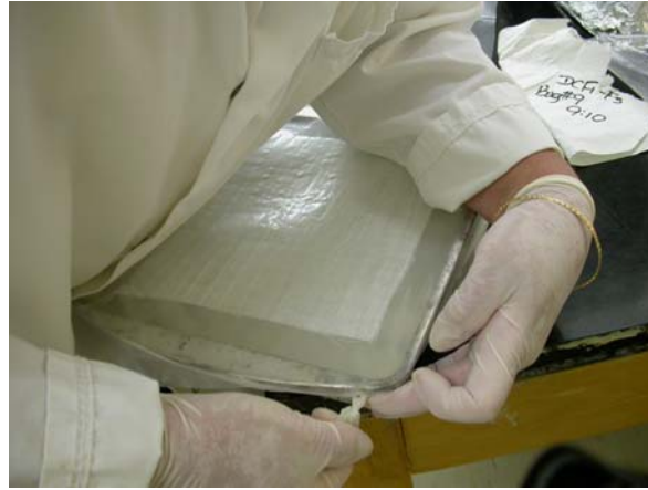
Scellage de la feuille supérieure au bac d'éclosion
