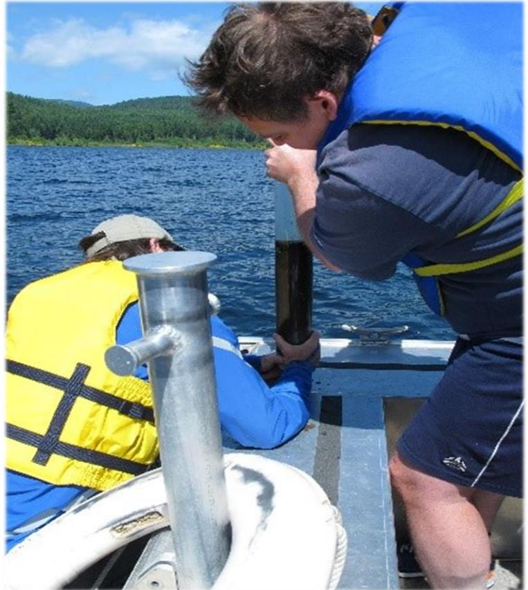
Figure 1 : Acquisition d'une carotte sédimentaire du réservoir de Sooke Lake à l'aide d'un carottier Kajak.
