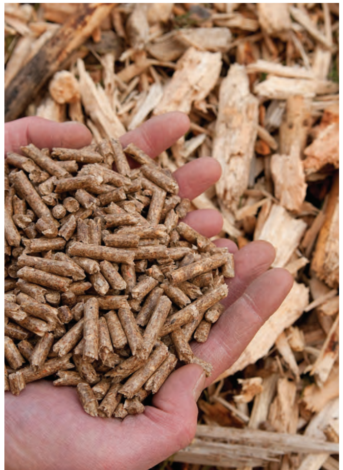
Les sciures et les copeaux de bois des scieries peuvent être utilisés pour fabriquer des panneaux, du papier ou des granules de bois.
