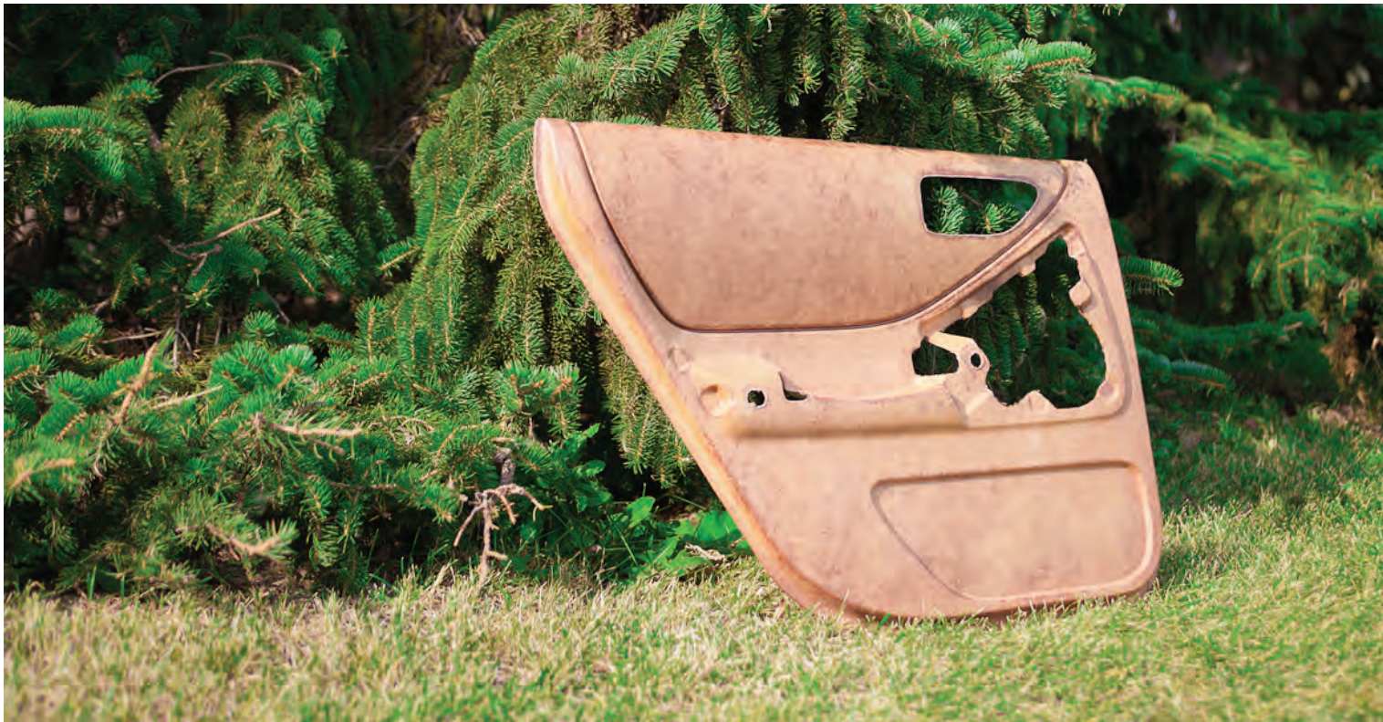
Un tapis de fibres de bois d'ingénierie pourrait remplacer les composants en fibre de verre qui entrent dans la composition des voitures.
