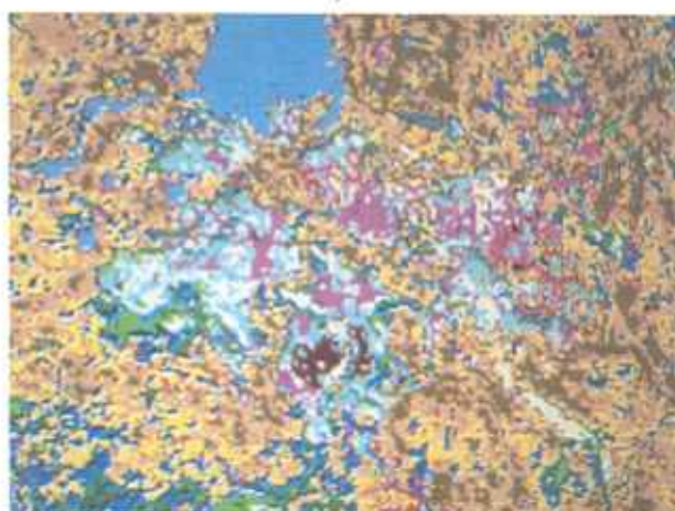
Figure 3. Classification non dirigée d'une image du Landsat l'été 1974 et/ou image de décision 1 produite par le PEF (sous-ensemble d'une image complète ne montrant que les régions où les activités se sont déroulées)
