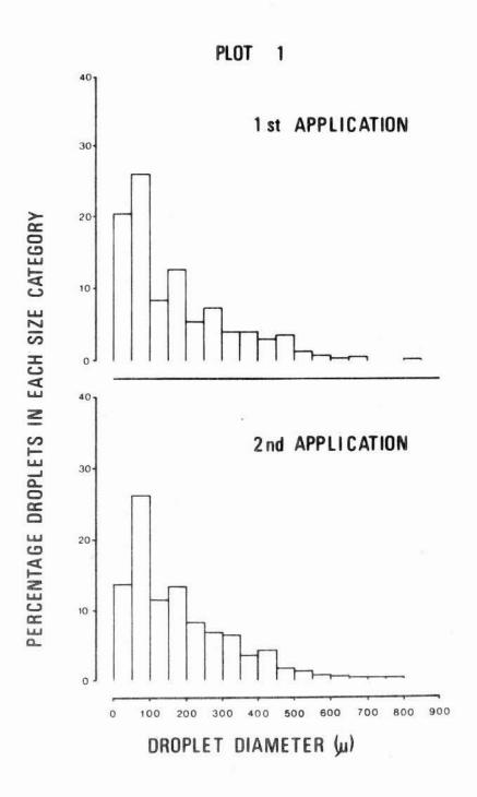
Fig. 2. Analysis of the spray drops on  $\mathsf{Kromekote}^{\textcircled{R}}\mathsf{cards}$  in plot #1.
